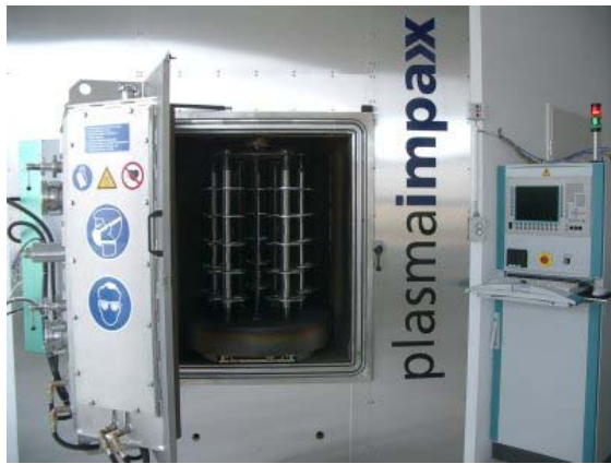
Abb. 3: Plasmaimpax - Beschichtungsanlage (Batch-System, offen) u. a. zur Herstellung von a-C:H-Schichten.
