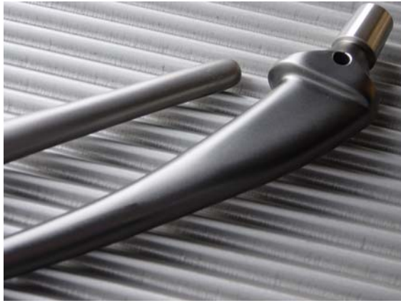
Abb. 10: Mit einer verschleißfesten und biokompatiblen a-C:H-Schicht (axyprotect®) versehenes Titan-Hüftimplantat.
