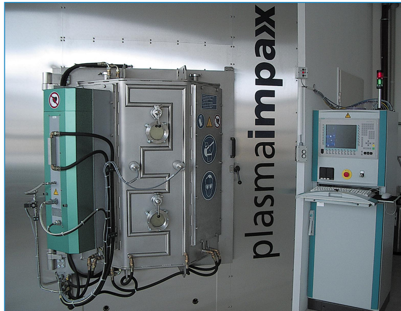
Plasmaimpax-Beschichtungssystem zur Beschichtung und Ionenbehandlung von Implantaten und Bauteilen für die Medizintechnik sowie den Automobil- und Maschinenbau ■
